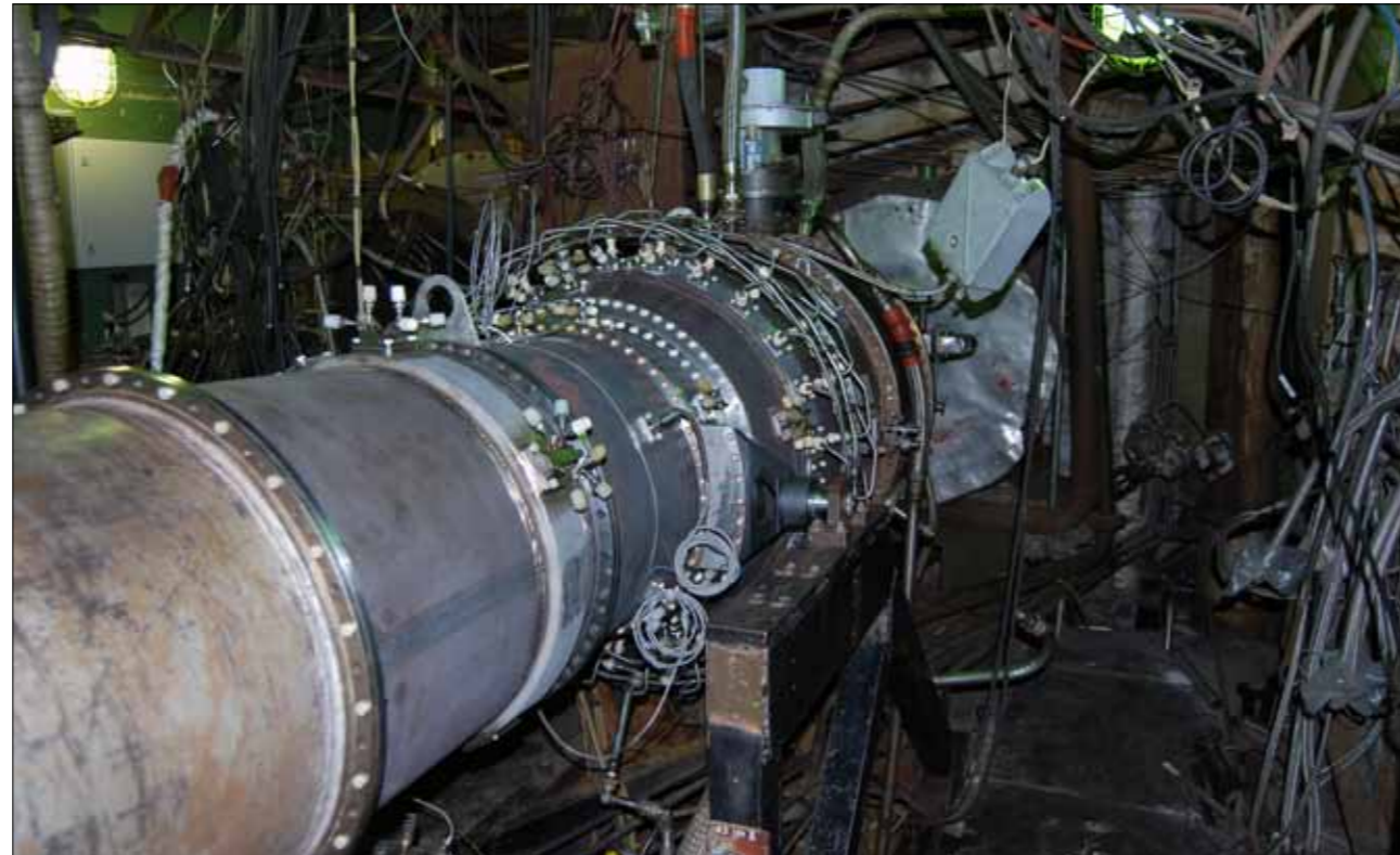
Во время доводки камеры сгорания для двигателя ПД-14 на установке ПКС-100. ОАО «Авиадвигатель»
