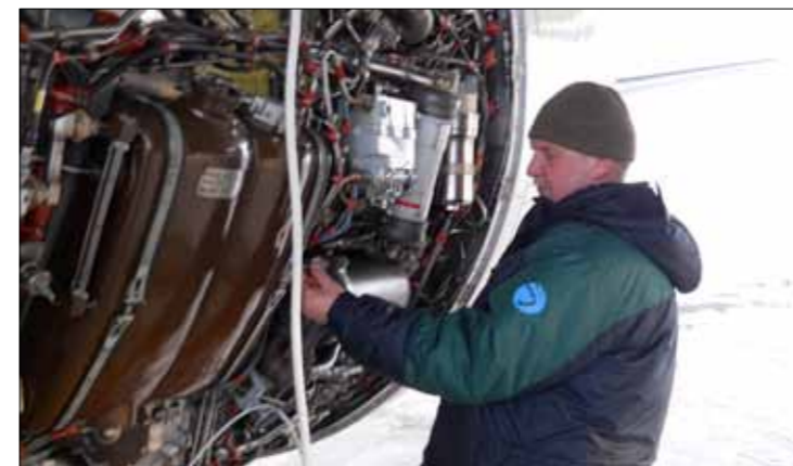
Механик-испытатель Андрей Воронин проводит осмотр наружной обвязки двигателя ПС-90А2 после очередного полета
