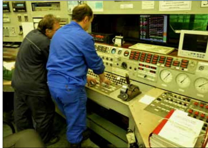
Пульт управления двигателем ПС-90А. Испытательный стенд ОАО «Пермский моторный завод»
