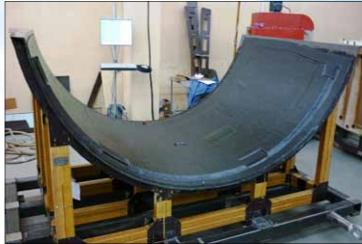
Обтекатель мотогондолы авиационного двигателя нового поколения, выполненный из композиционных материалов
