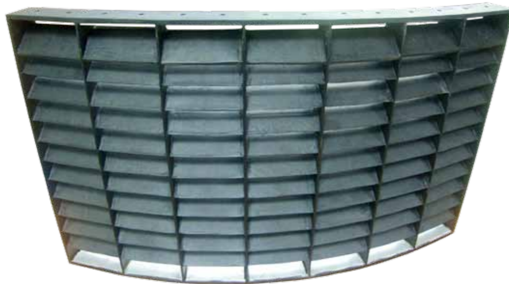
Решетка реверсивного устройства из углепластика
