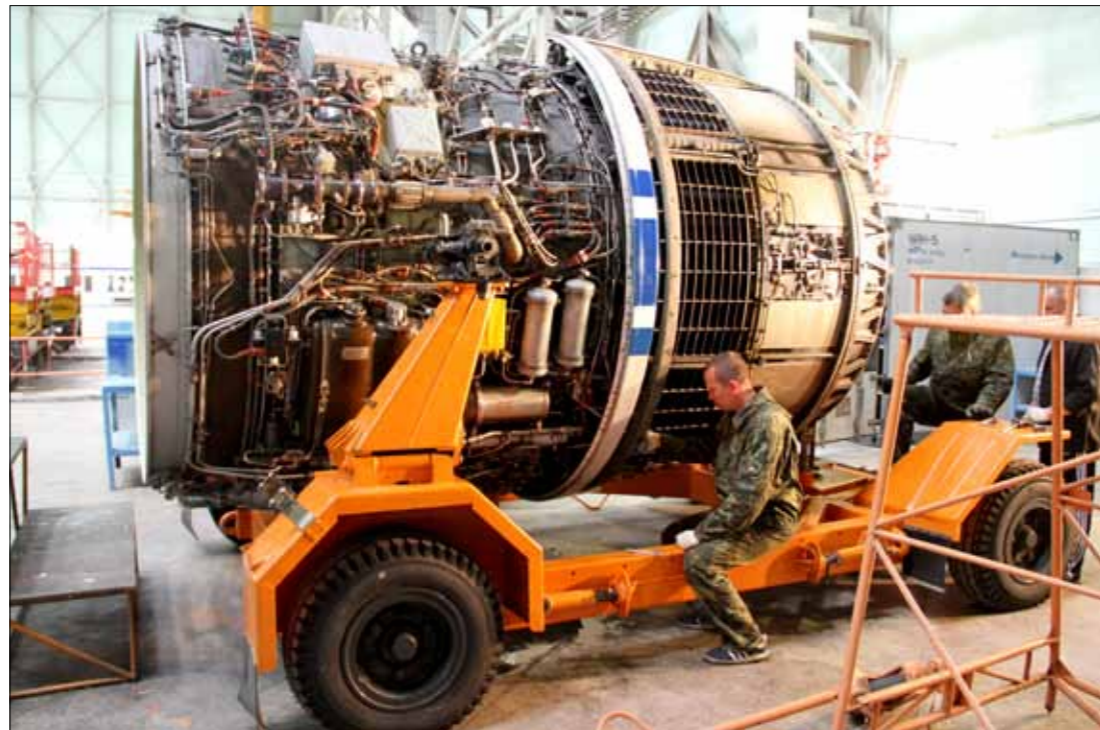
Участок модульного ремонта ПС-90А на базе летно-испытательного комплекса ЗАО «Авиастар-СП». Подготовка к демонтажу реверсивного устройства двигателя ПС-90А-76
